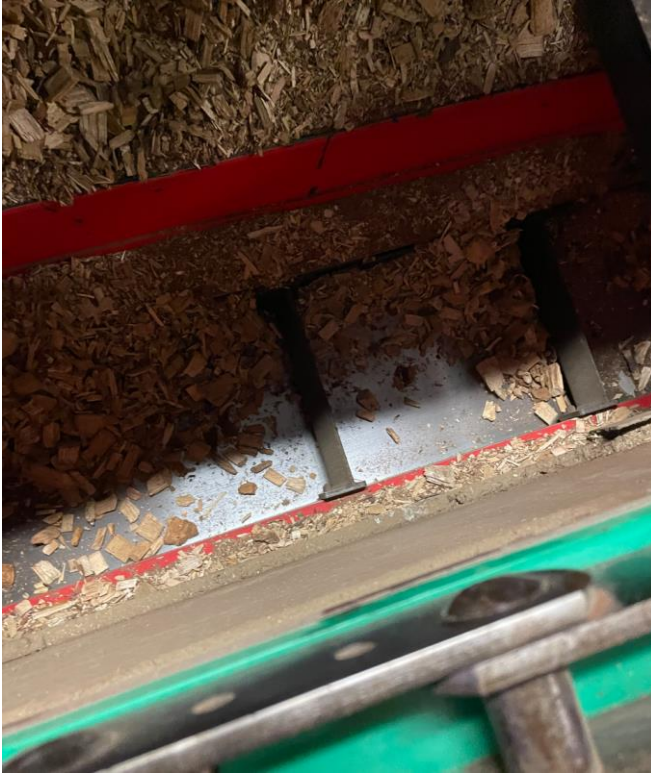
Kuva 4. Kolakuljettimen kola, ketjut ja johteet.
